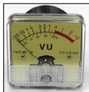
VUメータは左の写真のようなメータで、音声や音楽の信号レベルを表示するのに使います。針の振れ具合が実際の音量の感じに合うよう、針が少しゆっくり振れるように工夫してあります。
