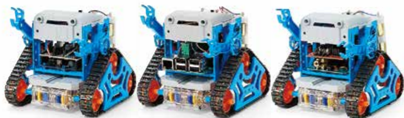
Arduino 搭載例 Raspberry Pi 搭載例 Ichigojam 搭載例
