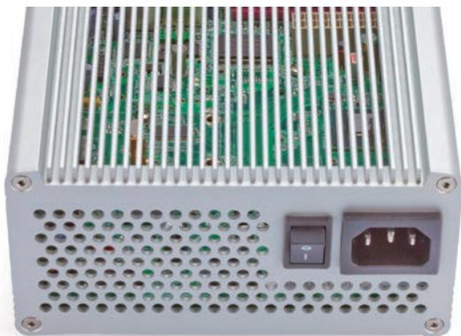
ヒートシンクカバーの内側の肉を削り取る事で谷間部分をスリット穴にする事が出来ます。
