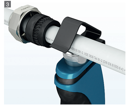
3 シールドケーブルの被覆を剥く
