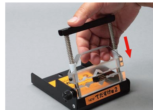
ワークをセットし、上部クランパーをそっと下ろします。両手が使えるので、すばやく確実に作業できます。
