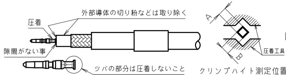
3 シェルを同軸ケーブルの絶縁体と外部導体の間に入る様に装着する。(プチンと中心コンタクトが定位置に入った事を確認する。)
