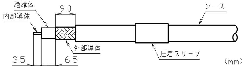
1 同軸ケーブルへ圧着スリーブを通し、絶縁体、外部導体、シースを図中の寸法で切り取る。
