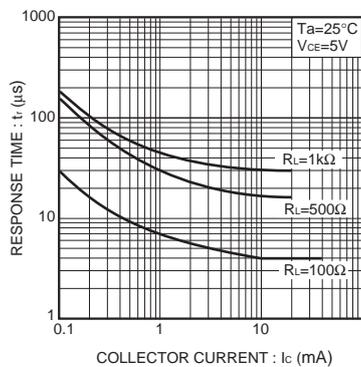
Fig.7 応答時間-コレクタ電流特性
