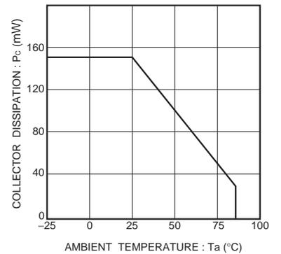
Fig.6 コレクタ損失-周囲温度特性
