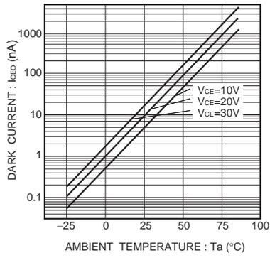
Fig.1 暗電流-周囲温度特性
