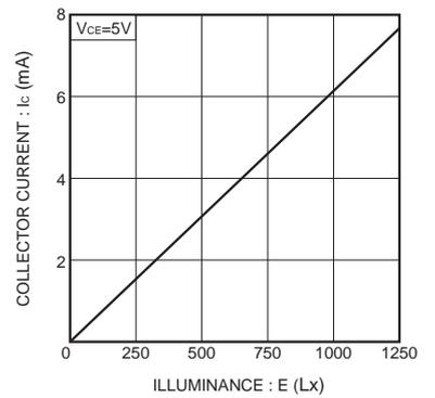
Fig.3 コレクタ電流-放射照度特性
