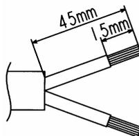
4-2-3 右図の様に結線し、端子ねじを締め付ける。
