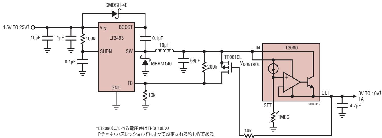
\*LT3080に加わる電圧差はTP0610LのPチャネル・スレッショルドによって設定される約1.4Vである。
