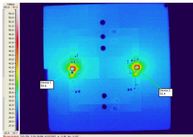
図5. 700mWを消費するときの温度上昇
