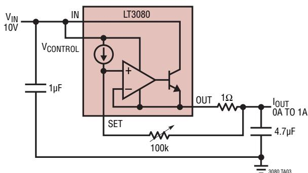
低損失電圧のLEDドライバ
