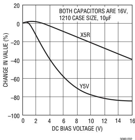
図2. セラミック・コンデンサのDCバイアス特性
