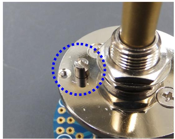
隣のネジ穴に取り付けて完了です
