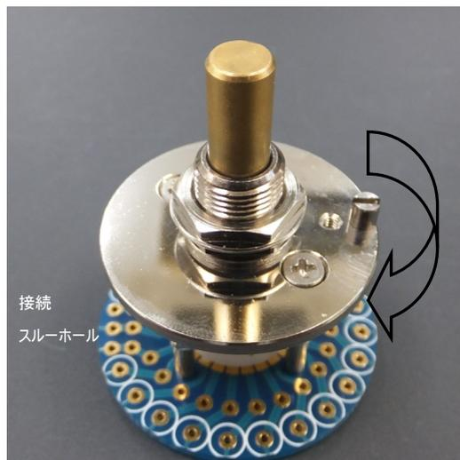
取付板全体を180度回し、ネジで固定します。
