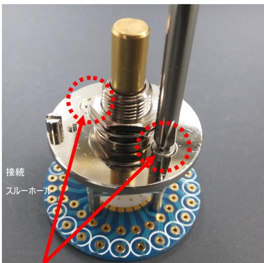
プラスドライバーでネジを外します。
