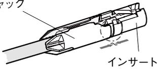
3. ワイヤをインサートに半田付けしチャックとの凸凹を合わせます。
