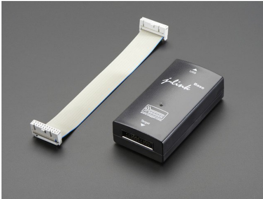
SEGGER J-Link BASE - JTAG/SWD Debugger
