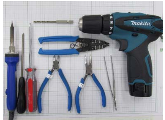
図2 必要な工具類 ドリル(ドリル径はφ3~φ3.5mm)、被膜をむくワイヤstrippaや精密ドライバもあると便利
