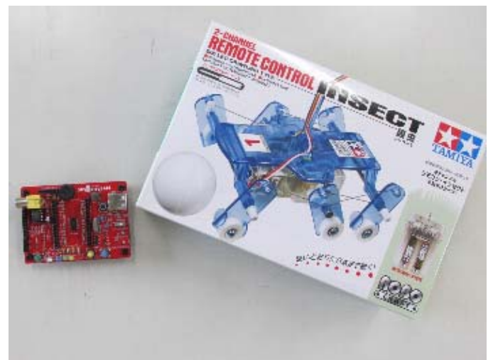
図3 SkyBerryJAM と昆虫ロボットキット
