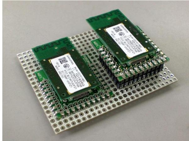
モジュールを基板に固定する場合は、0.5mm 厚の両面テープを、モジュール裏の金属シールドの平らな面に貼り付け、基板に貼り付けるようにして固定してください。
