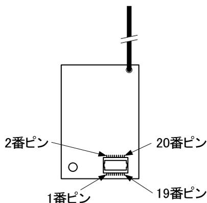
図 7 IM920c 端子配置図 (コネクタ面視)
