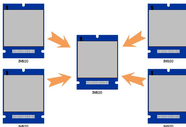
図 3 送信モジュールが複数、受信モジュールが 1 個の構成
