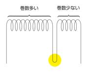
線のつながったコイルのイメージ図です。 黄丸部分をカットしてコイルを2つに分けます。
