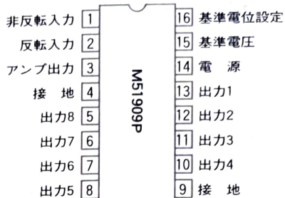
ピン接続図(上面図)
