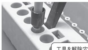
工具を解除穴に挿し棒端子を引き抜きます。
