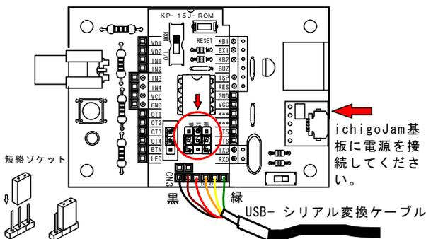
JP2設定が「ISP」ON側になっていることを確認してからIchigoJam基板の電源を一旦OFFにした後、再びONにしてください。
