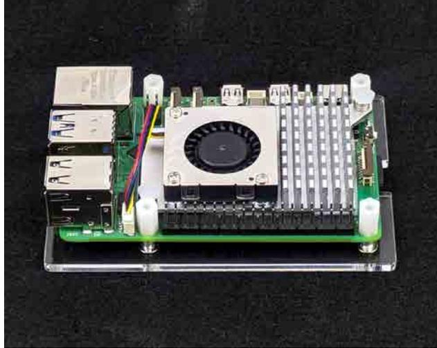
⑥アクリル板(天板FANタイプ)の丸穴スペーサーの穴に合わせて置き、短いトラスネジ(5mm)で固定します。
