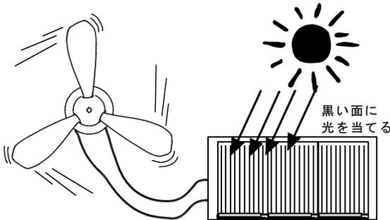
※ソーラーパネルに十分な光が当たっていないと、DCモータへ回転に十分な電力を供給できません。ソーラーパネル単体で端子間計測して電圧が、あった場合でもDCモータを接続すると電圧が下がる場合は光量不足（供給電流不足）です。
