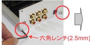
短い方のネジ(M3×6mm)を使用します
