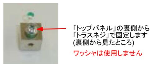
①-3 「タッチスクリーンディスプレイ」の上に「トップパネル」を置いて「六角スペーサ M3×45mm」でネジ止めします(4カ所)
