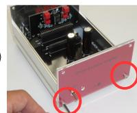
・「フロントパネル」と「着せ替えパネル」と「アクリルパネル」の3枚を重ねてネジ止めします(2カ所)
