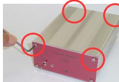
・「フロントパネル」には長いネジ(M3×10mm)を、リアパネルには短いネジ(M3×6mm)を使用します
