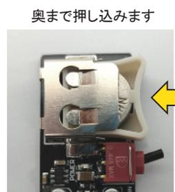
電池の取り付け後、スイッチをON側に倒すと
