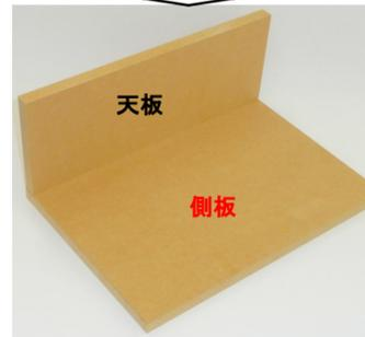
「側板」の上に「天板」を乗せて手で押し付けて圧着します
