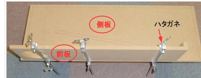
「側板」は長さ840mmもあるのでどうしても「反り」が発生します。「反り」を矯正して「前板」とスキマなく接着するために「ハタガネ」の使用をおすすめします
