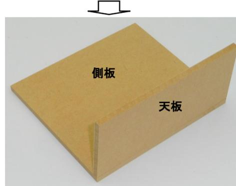
ボンドを塗った面を「側板」の上に置き、手で押し付けながら位置を合わせます
