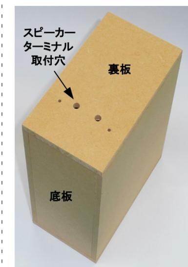
「天板」と「底板」および2枚の「側板」の端面全周にボンドを塗ります
