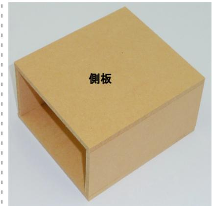
「天板」と「底板」の端面にボンドを塗ります
