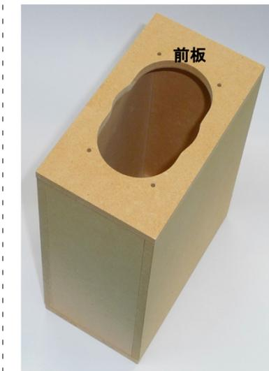
「天板」と「底板」および2枚の「側板」の端面全周にボンドを塗ります
