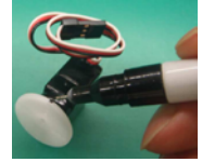
側面に油性マジックで印しを付けておくと何処が回転範囲の中心かわかります。
