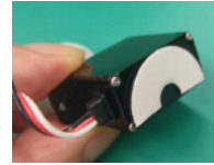
丸型両面テープをケース底に付ける場合は半分に切断すれば、ちょうど良いサイズになります。
